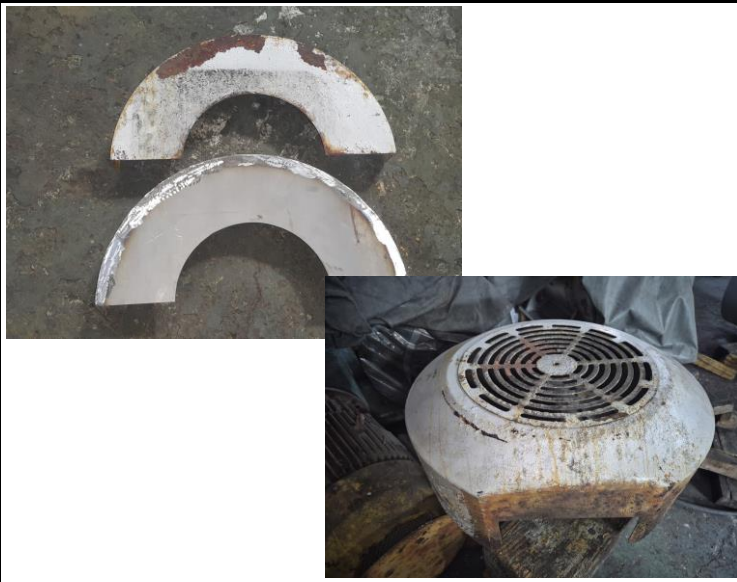
조립부품 SHAFT축 우천COVER & FAN COVER 제작교환
