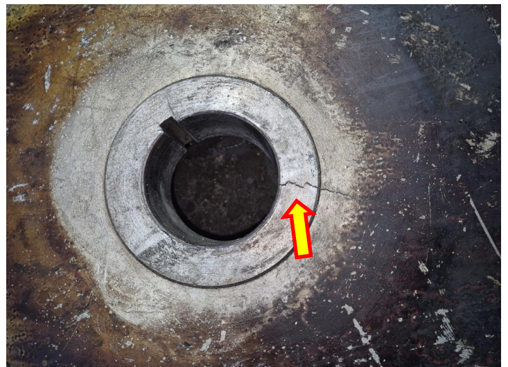
외부 FAN CRACK현상있으나 WELDING사용하면 될것으로 보임
