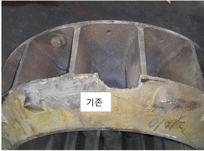
외부 FAN UNBALANCE교정하면 기능에는 영향이 없을것으로 판단 됨
