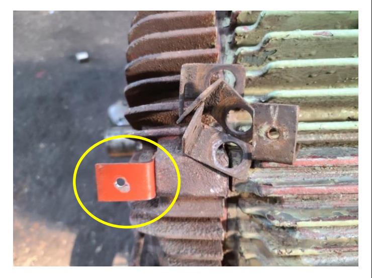
조립 부품 FAN COVER고경 BRACKET 4EA교환
