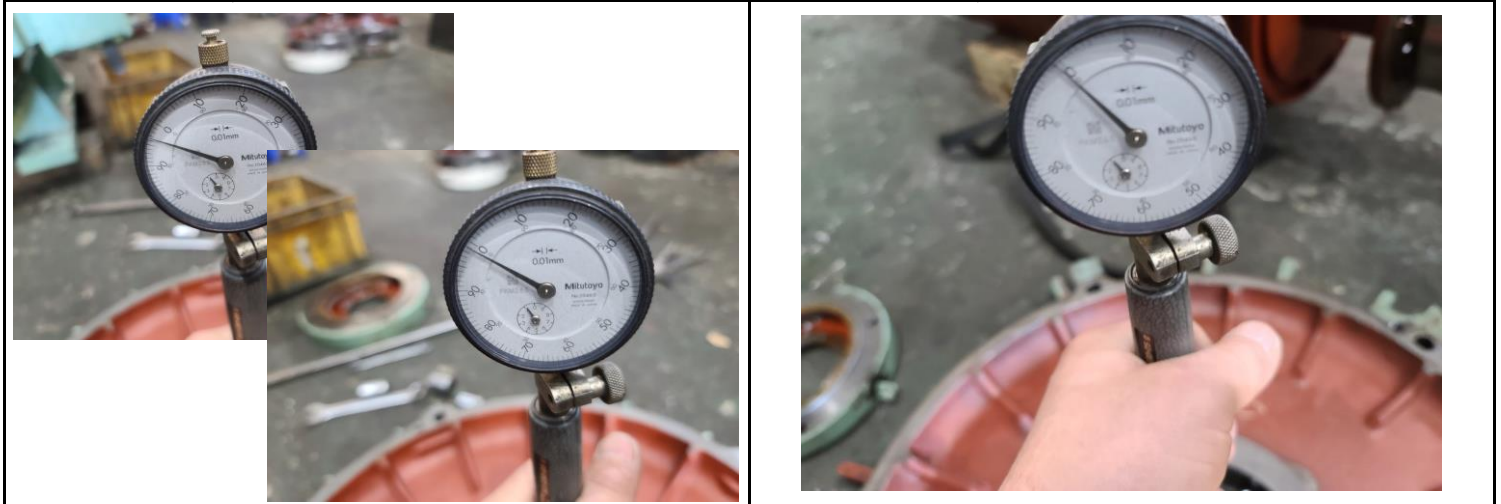
입고검사 부하측 HOUSING 검사 1~ 5/100로 불량 입고검사 반부하측 HOUSING 검사 1/100로 양호
