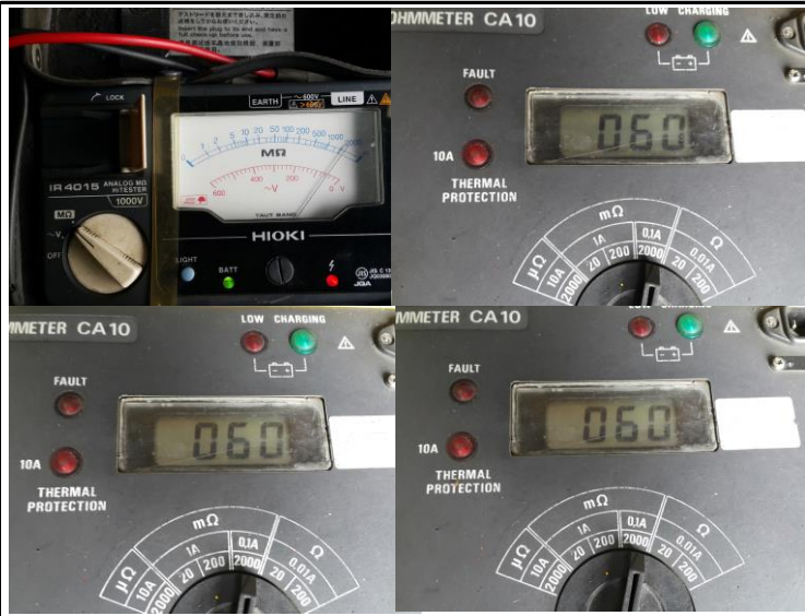
출고 검사 A MOTOR 절연저항 및 각상별 권선저항
