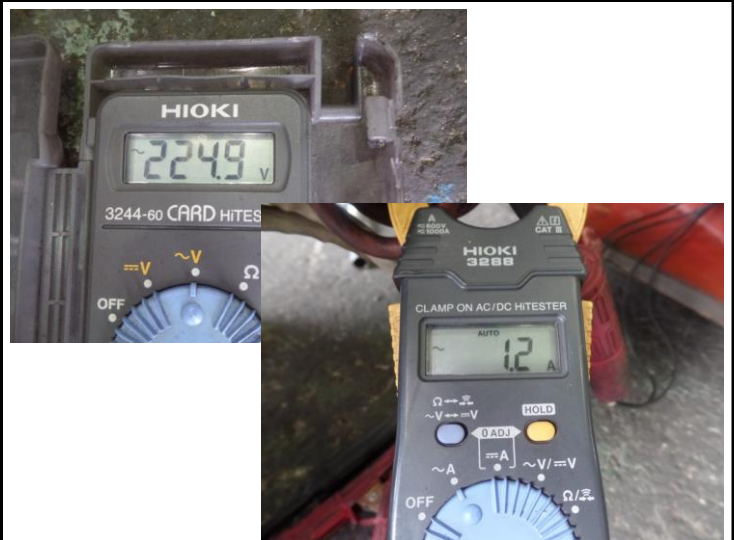
HEATER검사 4회감아 2개 병렬 CURRENT
